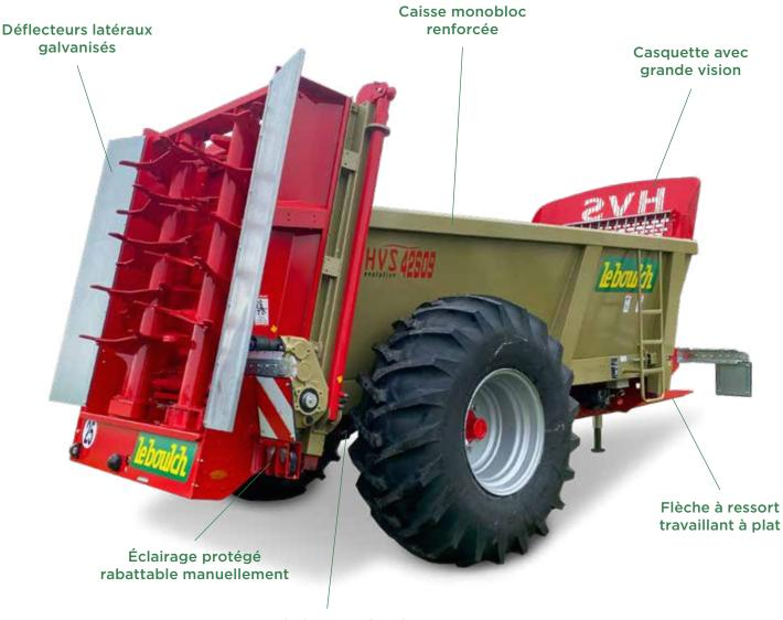
Transmission sous l'essieu pour le point de gravité le plus bas du marché
